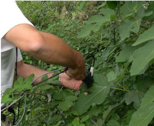
Fig. 10 – Fasi di rilevamento delle firme spettrali in campagna.
