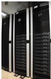
Il cluster per l'elaborazione di dati radar satellitari, è stato progettato e realizzato presso l'IREA con l'obiettivo di ottimizzare le prestazioni in funzione del particolare tipo di applicazione. L'architettura è composta 2 nodi di front end in heartbeat e 22 nodi di elaborazione a 64 bit. Lo spazio su disco complessivamente disponibile è di circa 1,8PB.
